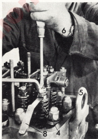
Fig. 63.—Ajuste de válvula exterior (2.ª fase)
