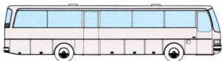
Setra S 215 HRI-GT dans version de base avec portes passagers devant l'essieu avant et au milieu.
