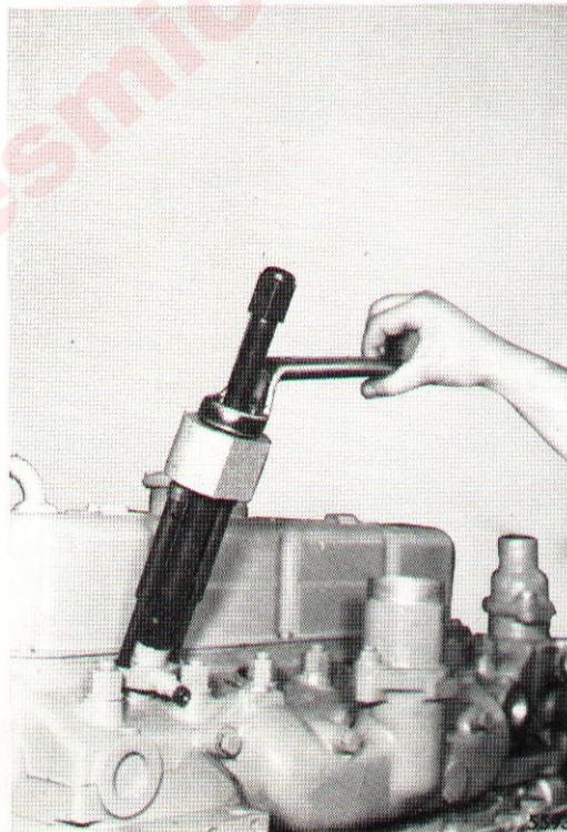
Fig. 3.—Desmontando los inyectores.
