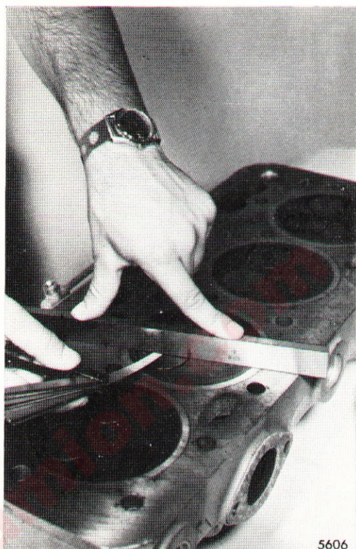
Fig. 16.—Midiendo la diferencia de altura entre planos de cabezas de válvulas y culata.
